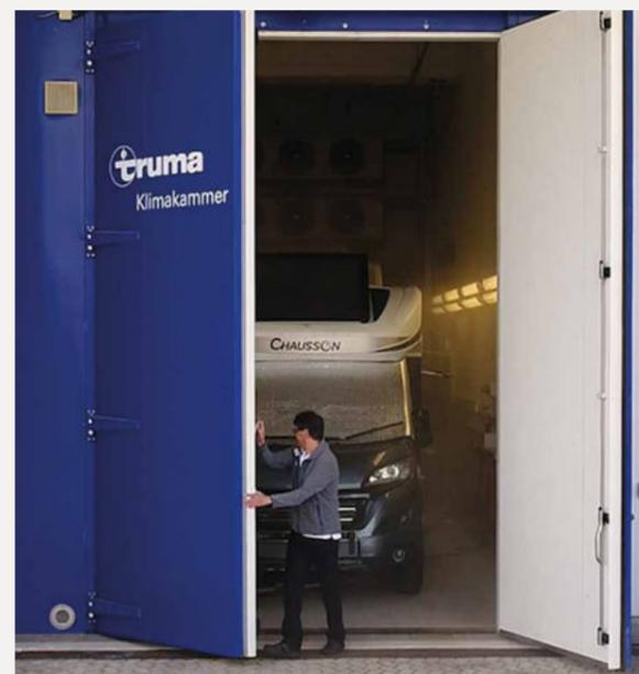
Die Norm EN1646-1 ist verbindlich: Für die höchste Stufe (Grade 3) wird verlangt, dass bei einer Außentemperatur von -15°C die Innentemperatur in weniger als 4 Stunden auf +20°C ansteigt.
